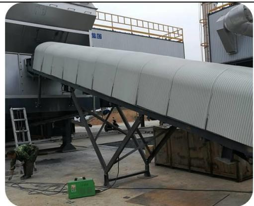
皮带机弧形皮带罩示意图
