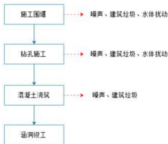
图2-37 涵洞施工工艺流程图
