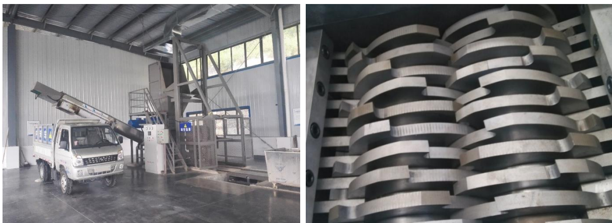
图 2.6-4 破碎机及高合金钢刀具
